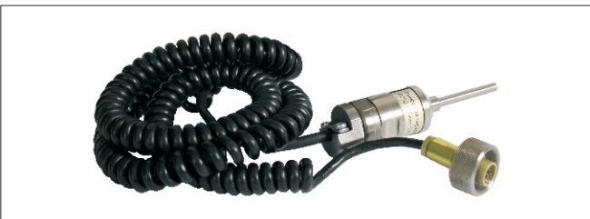
Съемный датчик температуры установлен в накладной магнитный термокарман
