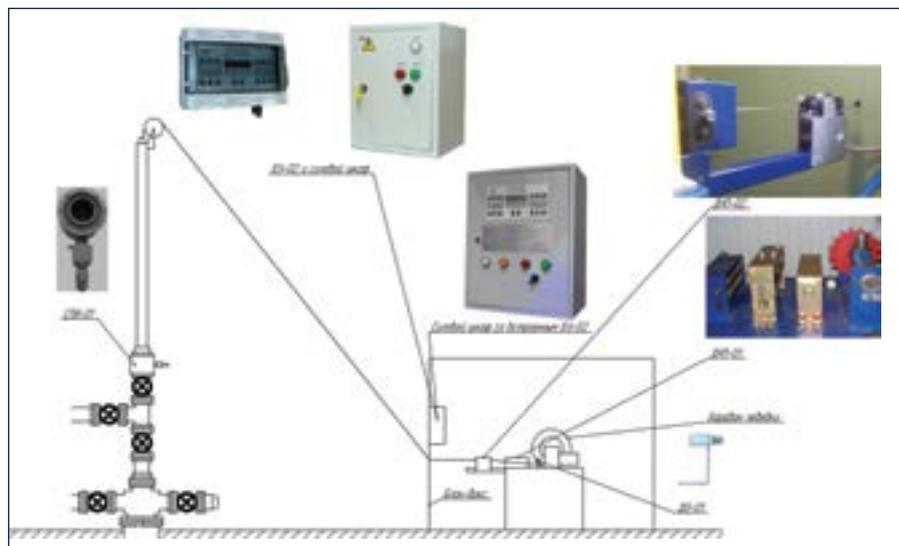
Рис. 1. Схема расположения СУ УДС УСПС-3000
