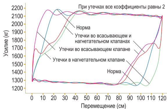
Рисунок 11. Сравнение динамограмм при утечках во всасывающем и в нагнетательном клапанах
